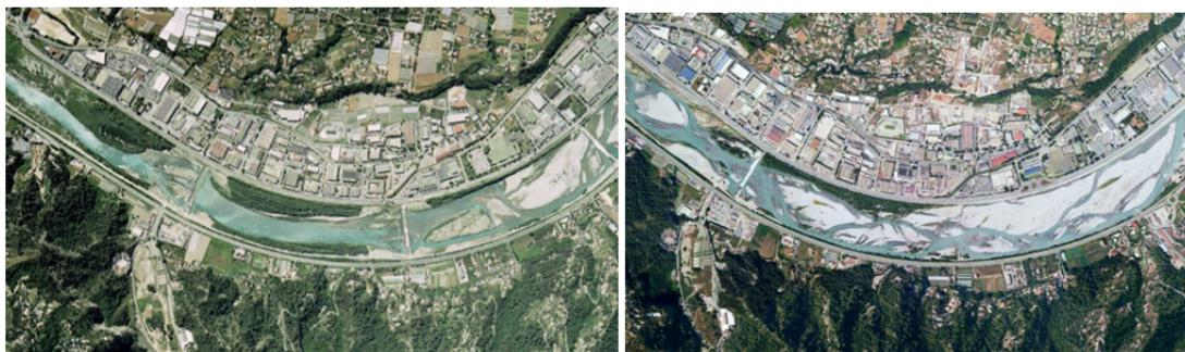
Figure 93 : photo aérienne d'un tronçon du Var de 1999 (à gauche) et de 2014 après abaissement des seuils
